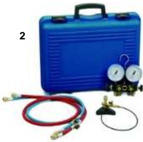
Kit gruppo manometrico e sistema di carica composto da gruppo manometrico a 4 vie con manometri Ø 80 "Pulse-Free", con o senza bilancia elettronica fino a 5 Kg, risoluzioni 1 gr, 2 tubi flessibili con valvola intermedia e raccordi, 1 supporto per bombola refrigerante, 1 tubo capillare con raccordi (600 mm), valigetta in plastica.
