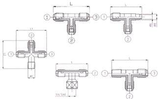
GIUNTO IN OTTONE A SALDARE F.x FILETTO M.- 1/4 6 mm
